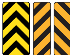
Balises à chevrons et balises de danger. Les lignes vers le bas indiquent la direction à suivre.
