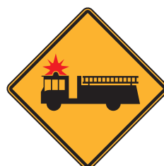
Signal avancé d'entrée de camions d'incendie
