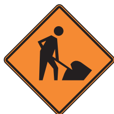
Signal avancé de travaux routiers
