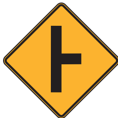
Signal avancé d'intersection masquée
