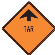
Signal avancé de travaux de goudronnage
