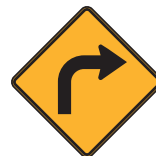
Signal avancé de virage à droite. Vitesse maximale recommandée pour cette courbe
