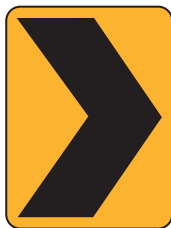
Chevron pour diriger les conducteurs dans les courbes prononcées
